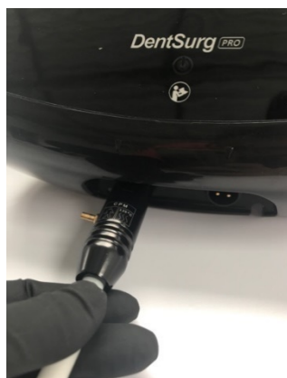
Figura 29 (A) e (B): Conexão e desconexão do cabo da peça de mão a unidade principal
