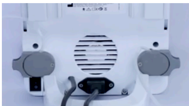
Figura 3: Bomba peristáltica montada no equipamento DentSurg Pro
