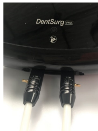
Figura 29 (A) e (B): Conexão e desconexão do cabo da peça de mão a unidade principal
