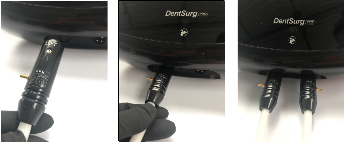
Figura 1: Detalhe do conector elétrico das peças de mão.
