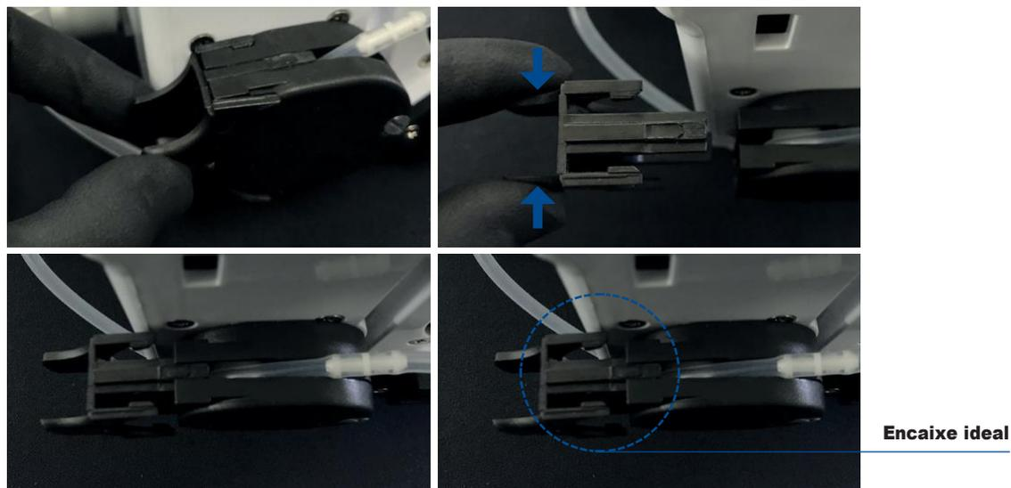
Figura 8: Reposicione a mangueira de silicone, pressione as aletas da gaveta e empurre-a em direção ao corpo principal até o encaixe ideal.
