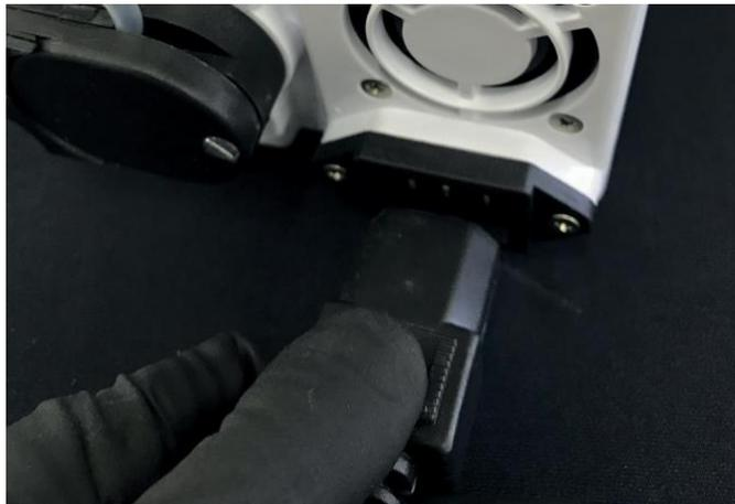
Segure o conector do cabo de alimentação conforme a imagem e encaixe na parte traseira da unidade principal. Utilize a outra mão para apoiar a unidade principal. Certifique-se que o cabo esteja completamente conectado. A outra extremidade do cabo deve ser conectada na tomada do seu consultório.
