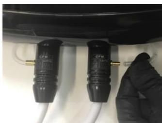
Sujete el conector del cable de la pieza de mano y encaje la extremidad de la manguera de la bomba peristáltica, tal como se muestra en la imagen. Aplicando una leve fuerza, coloque la manguera hasta el final del conector. Para retirar: sujete la manguera y aplique una leve fuerza, tirando de la manguera.
