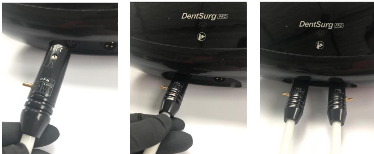
Figura 1: Detalle del conector eléctrico de las piezas de mano.
