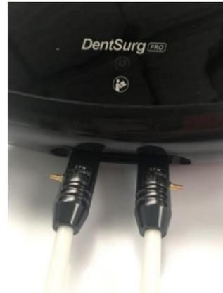
Sujete la región del conector del cable de la pieza de mano (A). Encaje la pieza de mano en el conector frontal del equipo. Presione para una completa fijación. En la imagen (B), el conector está totalmente fijado a la unidad principal. Para desconectarlo, sujete el conector y tire en la dirección opuesta al conector.
