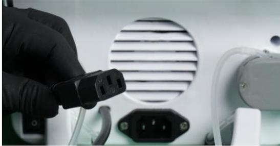
Sujete el conector del cable de alimentación como muestra la imagen y encájelo en la parte trasera de la unidad principal. Utilice la otra mano para brindar apoyo a la unidad principal. Asegúrese de que el cable esté completamente conectado, tal como muestra la imagen. La otra extremidad del cable debe conectarse al tomacorriente.
