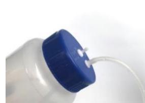
Imagen (A): El operador debe sujetar la botella con la tapa fija y colocar la manguera de la bomba peristáltica en el conector ubicado en la tapa de la botella. Aplicando una leve fuerza, coloque la manguera hasta el final, tal como se muestra en la imagen (B). Para retirar: sujete la manguera en la misma posición de la imagen (A) y, aplicando una leve fuerza, tire de la manguera.
